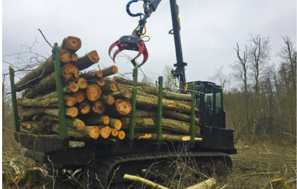
Hintereinander passen zwei Drei-Meter-Stöße nicht, zwischen den hinteren Rungen kann aber quergeladen werden. Foto: Diercks
